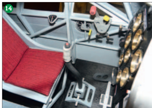
Der Kettenzug zu den Landeklappen ist ein optisch herausragendes Teil und stand deshalb auf der To-Do-Liste. Das provisorisch installierte Handrad mit Kurbel wird demnächst durch ein im 3D-Drucker erstelltes Exemplar ersetzt.
