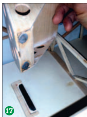
Der hintere Sitz in der Originalmaschine gleicht eher einem Campingstuhl und ist aus Stahlrohr geschweißt. Die Rückenlehne ist aber ebenfalls klappbar. Im Testmodell wurde das Unterteil des Sitzes analog zum Pilotensitz hergestellt. Die seitlichen Wangen sind so konstruiert, dass der Drehpunkt für die klappbare Rückenlehne höher liegt
