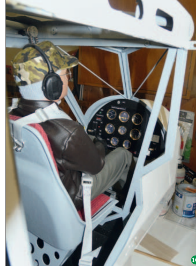
10 Bevor es mit dem Rumpfausbau weitergeht, wird erst das komplette Cockpit ausgebaut und die Einbauten angepasst. So schön es nach der Fertigstellung auch aussieht, für die weiteren Arbeitsgänge muss die Einrichtung leider wieder raus, damit man frei im Rumpf agieren kann
