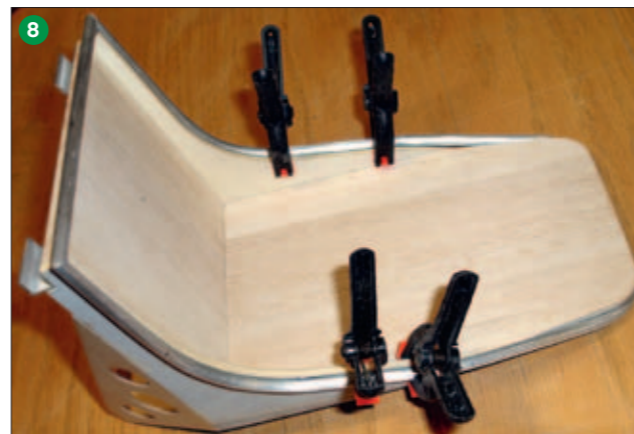
7 Die Holzteile für den Pilotensitz sind ebenfalls im Cockpit-Bausatz der Storchschmiede enthalten. Wer die Umrandung haben möchte, muss sie selbst aus 3-mm-Alurohr biegen. Wie das geht, ist auf der Firmen-Homepage ( www.storchschmiede.de ) zu sehen
